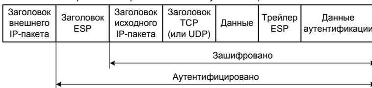
Рис. 3. IP-пакет после применения протокола ESP в транспортном и туннельном режимах
