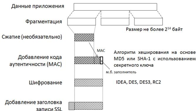
Рис. 2. Общая схема работы протокола записи SSL
