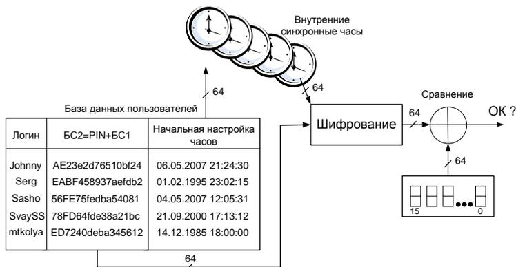
Рис. 2. Схема организации серверной части комплекса
